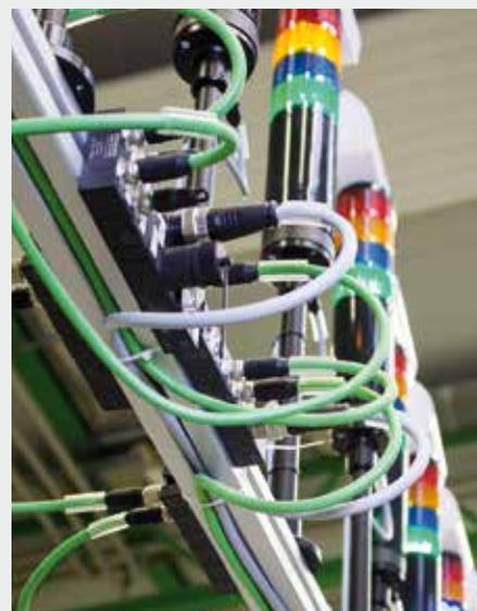
当然，Cube67 线缆模块不仅可以连接指示灯，而且还可以支持其他传感器和执行器，多达 16 个多功能参数的输入或输出可以使用。Cube67 模块线缆可提供不同的连接线长度和配置，包括具有尾端开放的连接线。
