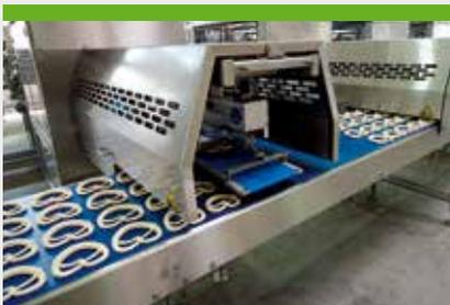
坚固耐用的IP69K Cube模块采用卫生设计，是可适用于食品区域的安装解决方案。不需要昂贵的接线盒和复杂的安装。可将多条需要不锈钢屏蔽的布线使用一条Cube系统线代替，这样可以将成本降至最低。
